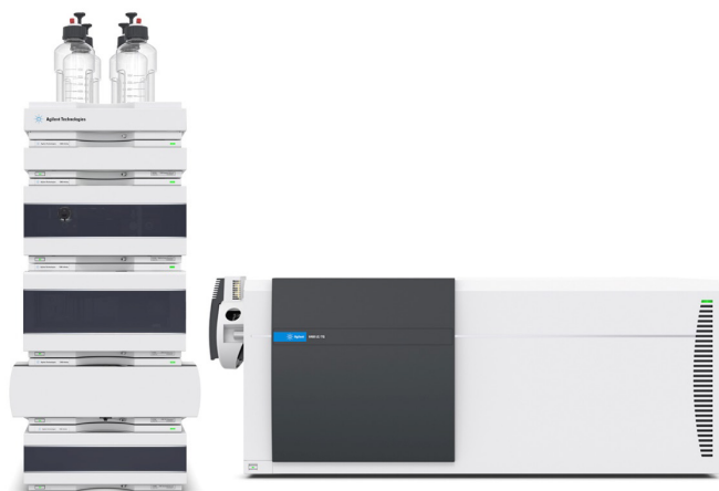
图 1. 安捷伦 Infinity LC Clinical Edition/K6460 液相色谱串联质谱系统
