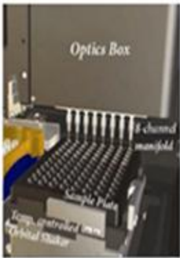
ForteBio Octet®检测仪器内部结构
