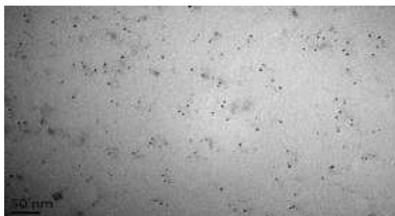
图1 CdTe QDs 的 TEM 图 (标尺=50 nm)
